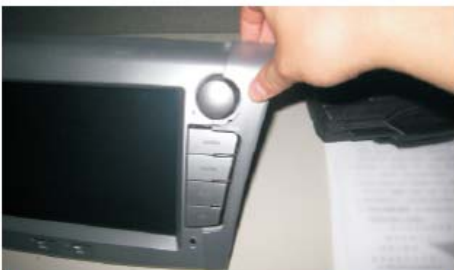
13 拆掉右侧装饰板
