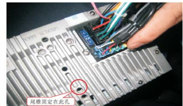
30 将专用转接线与主机对接上 安装主机定位柱
