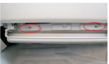
09 取掉储物箱下方的2颗固定螺丝
