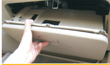
38 安装储物箱，对应固定5颗螺丝
