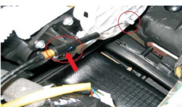
15 取掉空调拉线
