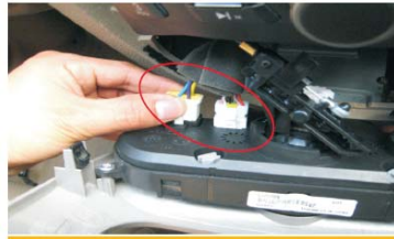
20 拔掉空调控制器2个插头
