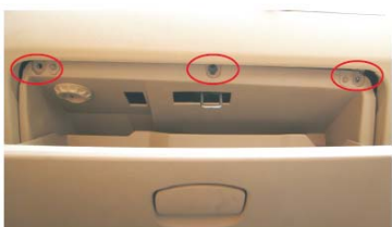
10 取掉储物箱上方的3颗固定螺丝
