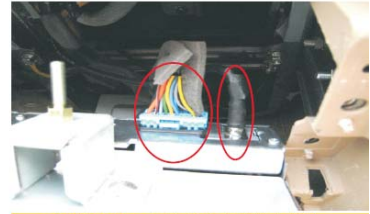
24 拔掉原车CD主机的电源/音响插头 收音天线插头
