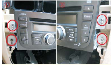
22 拆掉原车CD主机的4颗固定螺丝
