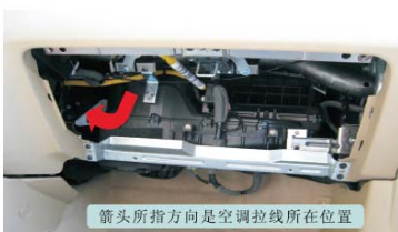
12 取出储物箱后的效果 箭头所指方向是空调拉线所在位置
