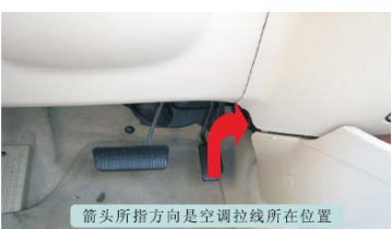
14 驾驶员空调拉线所在位置 箭头所指方向是空调拉线所在位置
