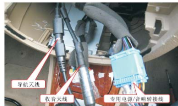
29 对插上专用转接线 导航天线 收音天线
