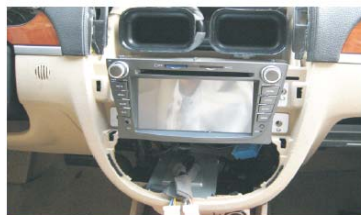
31 将主机推入螺丝固定卡位， 通电测试主机功能
