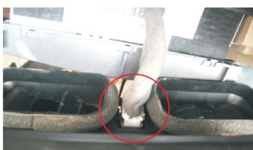
18 拔掉应急灯开关插头
