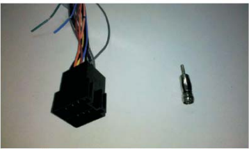
13 10款车型：找出附件里的电源线和天线转接头，并和原车对接。
