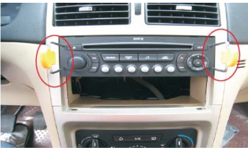
07 插上307原车CD专用拆卸工具
