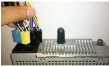
11 10款车型：取掉原车CD主机后面的电源/音响插头、收音天线插头
