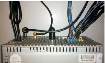
16 10款车型：对插上主机电源/音响连接线、收音天线、GPS天线、机尾连接线束等
