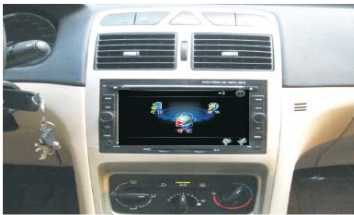
17 连接并检查各连接线束，把USB引到储物箱，将机器平稳推入合适卡位，测试机器
