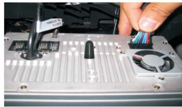
15 08款、09款车型：对插上主机电源/音响连接线、收音天线、GPS天线、机尾连接线束等
