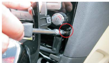
12 拧下空调控制面板下部两侧的螺钉
