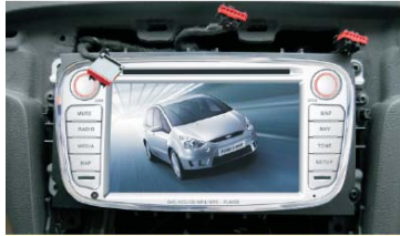
19 将本机装入车内，测试OK后拧上螺钉固定
