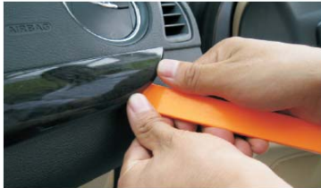
04 用胶刀将原车的装饰条，从右端开始撬起
