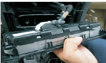
14 拔出空调控制面板背面的线束
