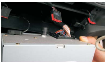
17 拔出原车CD机背面的线束
