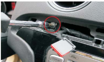
08 拧下空调控制面板上部两侧的螺钉
