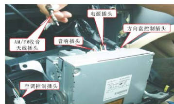
15 取掉空调控制插头, 取掉原车CD后面的收音天线/电源/音响/方向盘控制插头
