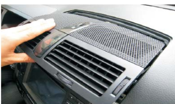
26 对插上应急灯开关插头； 将空调通风口推回原卡位
