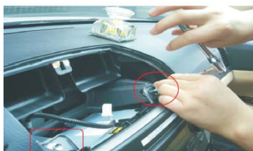
13 取掉原车主机上方的2颗螺丝
