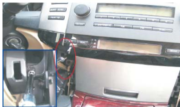
07 取掉原车CD主机左下方的固定螺丝
