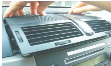
11 向外拉出空调通风口, 拔掉应急灯开关的插头
