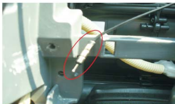
23 将不用的AM收音天线插头用绝缘胶布包扎好
