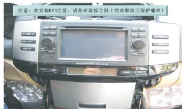
24 检查各连接线无误并通电测试主机有无异常 将丰田锐志专用主机推入螺丝固定卡位
