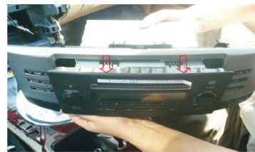
18 将原车CD主机从空调控制面框中取出
