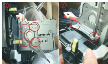
17 取掉原车CD主机固定支架的8颗螺丝 (左右各4颗) 取掉空调控制面板的4颗固定螺丝 (左右各2颗)
