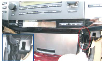
08 取掉原车CD主机右下方的固定螺丝
