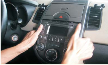
05 拆下装饰盖板
