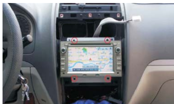
14 试用OK后打紧固定DVD机的四个螺丝
