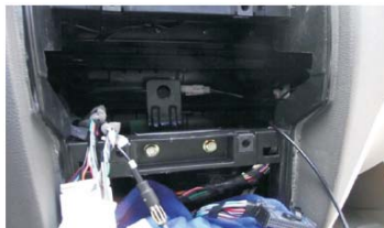
11 插上附件带的电源转接线
