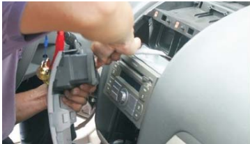
07 拆下中控盖板，拔下应急灯插头和空调控制线插头
