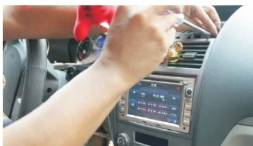
16 打紧三个固定中控盖板的螺丝
