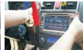
15 插上应急灯插头和空调控制线插头并装上中控盖板
