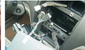
09 拆下CD机并拔下电源插头和收音天线插头
