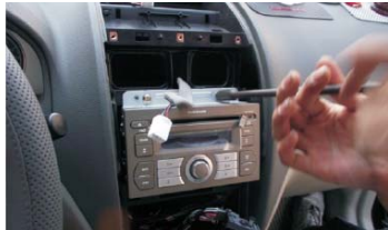
08 拆下固定CD机的四个螺丝
