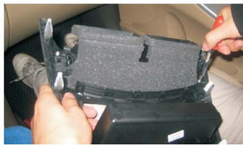
13 此步骤仅为低配置车操作步骤：拆下原外框空调出风口，并装到DVD导航机附带的外框上
