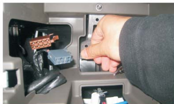
10 把车上和定位金属板折弯到后面，以免影响DVD导航机的安装
