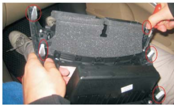
14 此步骤仅为低配置车操作步骤：拆下原外框上的白色扣子，并装到DVD导航机附带的外框上
