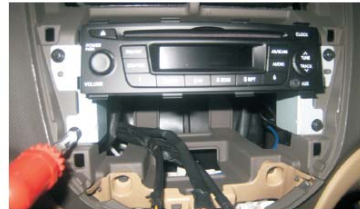
09 取下4个螺丝后，取出CD机，并拔下尾部连接线
