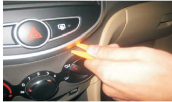
05 用毛巾把档位手柄盖好，用胶刀在下面的缺口位撬开外框。
