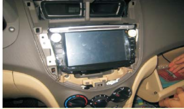
20 把主机装到位，开机测试OK后固定4个螺丝
