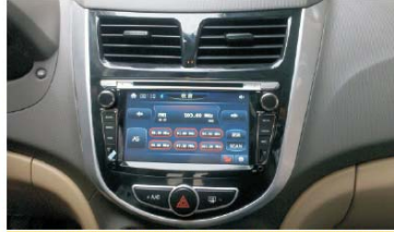
21 把空调盒三个接线对接好，装上前框（高配装原车外框，低配原装DVD导航附带的框），OK后即可享受视听新感受了
