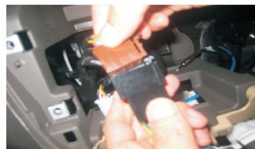
18 对接原车电源线，喇叭线
