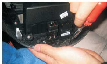
12 此步骤仅为低配置车操作步骤：拆下原外框空调盒，并装到DVD导航机附带的外框上
