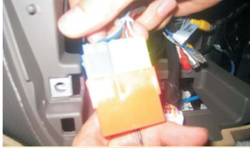
19 此步骤仅为高配置车操作步骤：对接方向盘控制线
