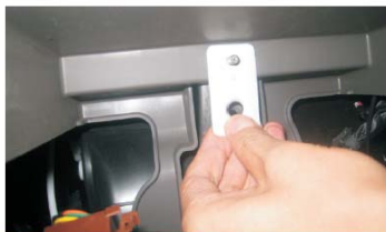
11 把DVD导航机包装附件里的“主机尾部固定板”装到车上
