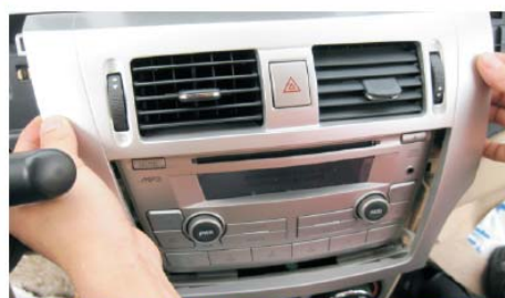
06 用撬刀撬松并取下空调面板, 拔出后端连接插头
