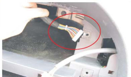
15 将连接主机与显示屏的线材按照图示穿到主机位置
