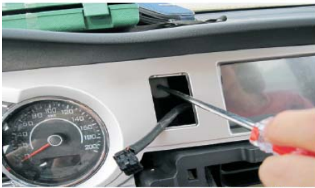
22 用十字螺丝刀固定好时间指示模块后面的螺钉
