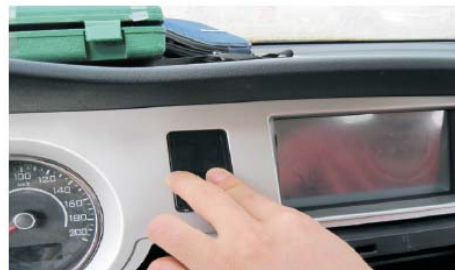
25 连接时间指示模块插座，并装配好
