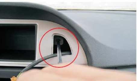
10 用十字螺丝刀取下乘客安全带指示灯后面的螺钉
