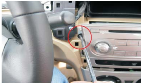
20 用螺丝刀固定好主机四颗螺钉
