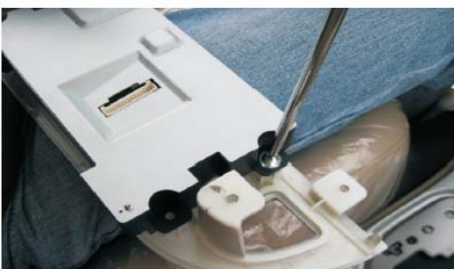
14 将导航显示屏用上一步拆下的四颗螺钉固定
