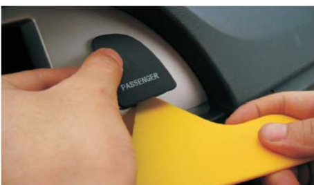
08 撬松并取出乘客安全带指示灯, 拔出后面插头
