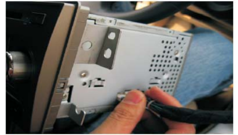
18 将屏连接线与主机连接
