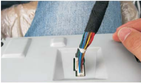
16 把屏连接线插头与显示屏连接
