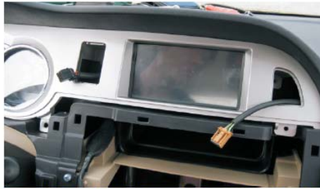
17 将原车仪表盘后面2处插座连接好，轻轻将仪表盘推入原位
