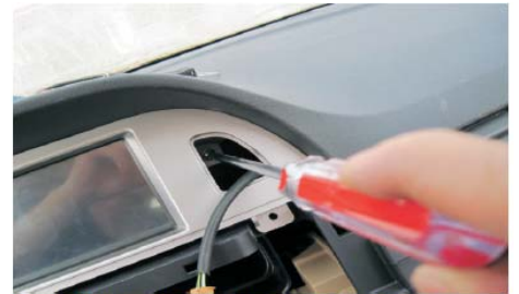
21 用十字螺丝刀固定好乘客安全带指示灯后面的螺钉
