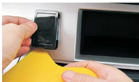
09 撬松并取出时间指示模块, 拔出后面插头
