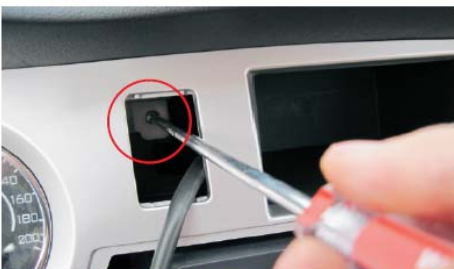
11 用十字螺丝刀取下时间指示模块后面的螺钉
