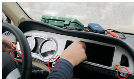
12 取下固定仪表板的3颗螺钉, 并拔出后面的连接插头
