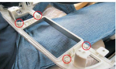
13 用十字螺丝刀取下固定储物盒的4颗螺钉
