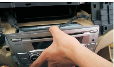
07 使用螺钉套筒取下固定主机四颗螺钉, 拔出主机连接线后取出主机
