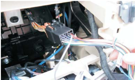
19 连接主机后端电源线、天线、AV线束，将USB尾线放到副驾驶位前储物盒中，并通电检查主机状态
