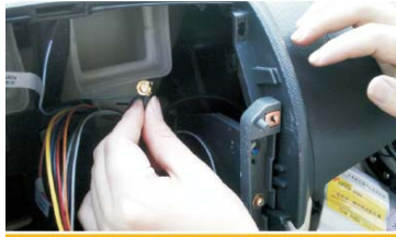
22 将GPS线顺着A柱穿过副驾驶前的储物盒，将GPS天线插头从原车CD位置牵出备用
