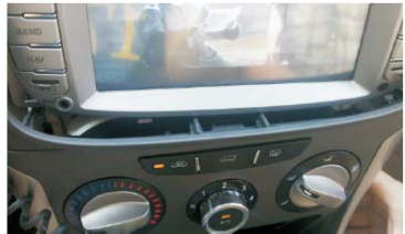
12 然后向外拉出空调控制面板至适当缝隙（注意不可完全拉出） NO PIC
