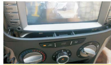
33 将空调出风口面板和空调控制面板的三个扣位扣住，然后装回原车
