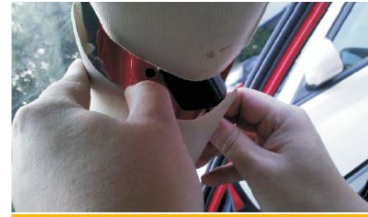
21 剥开右边A柱的密封条，撬开内饰板将GPS天线吸在钢板上面
