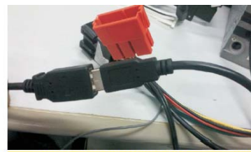
26 将FSV专用尾线上的USB公头插入FSV导航主机后面的USB母头
