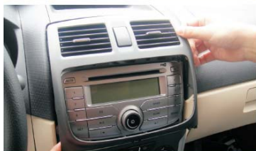
13 然后依次退掉空调出风面板和空调控制面板的3处扣位
