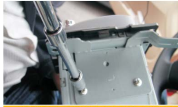
20 将原车左支架装上导航主机（只锁两颗螺丝）
