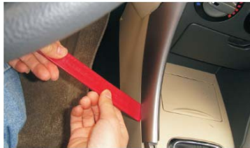
11 然后撬松空调控制面板底部左边
