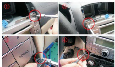
15 分别取下锁原车CD的4个螺丝（注意螺丝上的4个弹垫，不要掉进车内）
