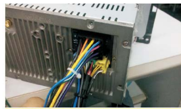
25 将FSV专用导航尾线公头分别插入主机的三个插座内
