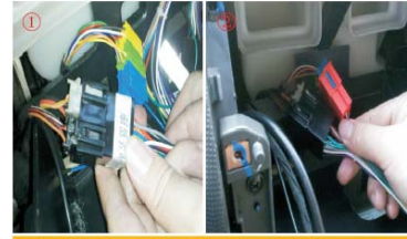
24 原车尾线和FSV专用导航尾线接法
