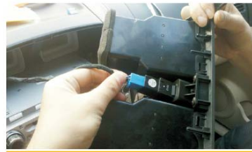
32 将应急灯插头插入应急开关插座
