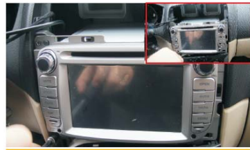
31 用原车螺丝锁FSV导航主机
