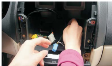
16 把掉原车CD机后面的接线头
