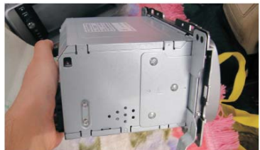
18 从原车CD机上取下左右安装支架（6颗螺丝留着备用）
