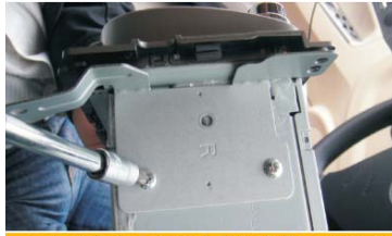
19 将原车右支架装上导航主机（只锁两颗螺丝）
