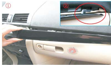
06 取掉原车小显示屏装饰条（注意装饰条尾端的小勾）
