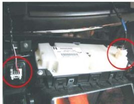
09 拔掉空调控制插头和应急灯开关插头
