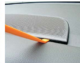
20 拆掉中控台上方中置喇叭盖板
