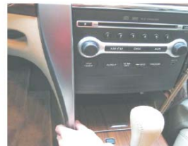
14 取下原车CD主机左侧的银色装饰条
