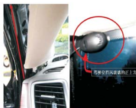
44 将蓝牙咪头牵引至驾驶室上方挡风玻璃上面
