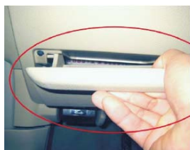
29 拆下方向盘左下方的小储物盒
