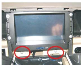
43 将显示屏推入固定卡位，固定上2颗螺丝
