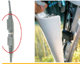
49 连接上导航天线插头，将GPS导航天线固定在副驾驶位的A柱内
