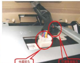
11 拔掉原车显示屏后的两个插头
