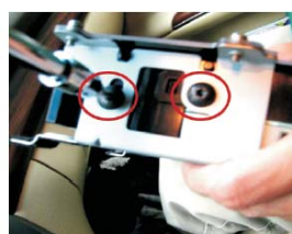
35 拆下原车显示屏上固定支架左右侧的螺丝
