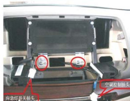
10 取下原车显示屏的两颗固定螺丝
