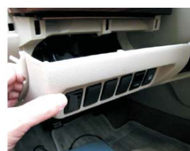
33 拆下方向盘下方的装饰板
