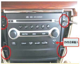
57 测试无误后，固定原车CD主机的螺丝
