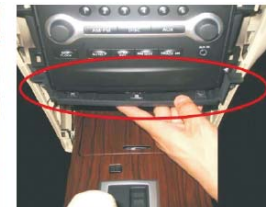
16 拆下原车CD主机底盖
