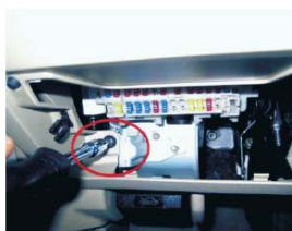
30 拆下小储物箱后面的螺丝
