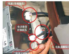
18 取出主机, 拔下原车CD主机后面的插头
