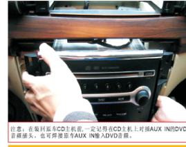
56 在原车CD主机AUX IN插上DVD音频插头，即通电开机测试主机各项功能
