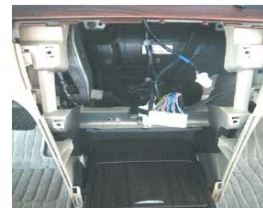
19 拆掉原车CD主机后的效果
