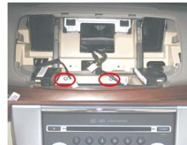
12 拆下原车六碟CD主机上方的2颗支架固定螺丝
