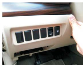
32 拆下方向盘下方的装饰板
