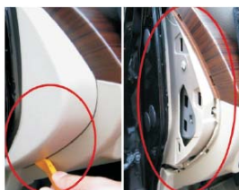
31 拆下左侧门旁的小盖板；拆下小盖板后的效果；
