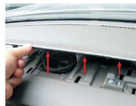
21 拆掉中控台上方中置喇叭盖板
