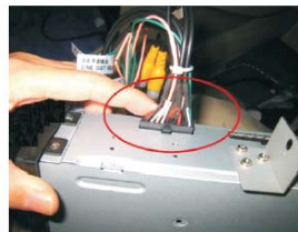
46 将音视频输入/输出插头对应插到DVD上面
