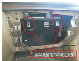
28 拆下储物箱后的效果
