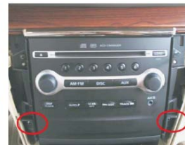
15 拆下原车CD主机两颗底盖固定螺丝
