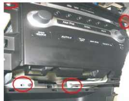
17 拆下原车CD主机2侧面板固定螺丝;拆下原车CD主机下方2颗支架固定螺丝;
