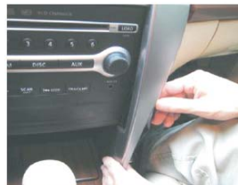
13 取下原车CD主机右侧的银色装饰条
