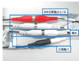
45 对应插上“DVD音频输出左/右”、“话筒输入”、“喇叭”插头
