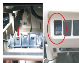
34 取下原车显示屏的两颗固定螺丝，拆下方向盘下方装饰板上面的任意预留开关
