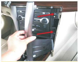
58 安装回原车CD主机左/右侧的银色装饰条
