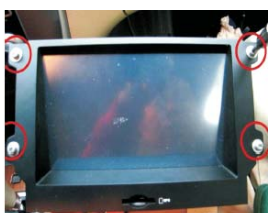
38 将原车显示屏固定支架安装到日产天籁显示屏上面
