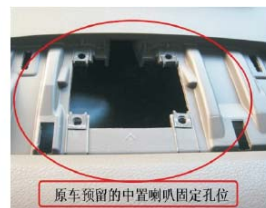
22 拆除中控台上方中置喇叭盖板后的效果
