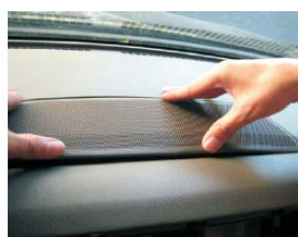
40 将中控台上方中置喇叭盖板安装回原位
