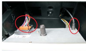
13 拔掉原车CD主机后的电源/音响插头收音天线插头
