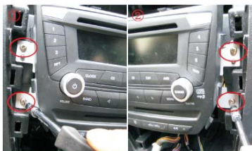
11 取掉原车CD主机的4颗固定螺丝
