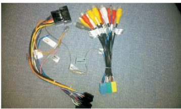
18 奔腾B50专用电源/音响转接线 注意方控线对接
