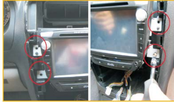
22 将主机推入固定卡位，固定主机的4颗螺丝
