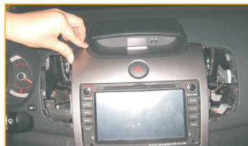
24 对插上应急灯开关插头及空调控制插头；将装饰面框和空调通风口安装回原位
