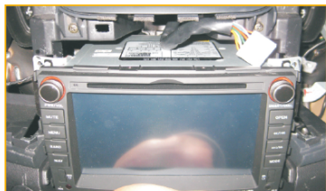
22 将起亚福锐迪专用主机推入固定卡位，通电测试主机
