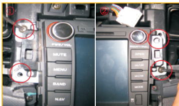
23 固定主机左右各两颗螺丝
