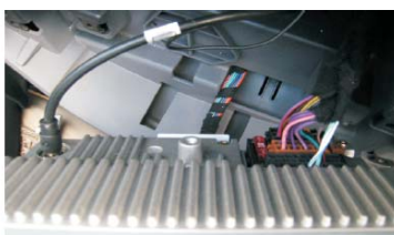
12 拔下CD机的电源插头和收音天线插头
