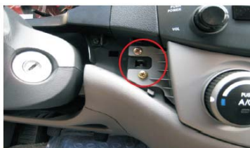
08 拆下空调控制面板的四个螺丝
