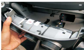
09 拆下空调控制面板
