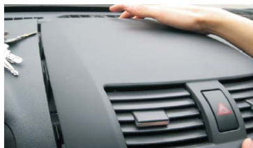
04 拆上边出风口盖板
