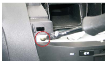
10 拆下固定CD机的四个螺丝
