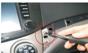
18 打紧固定空调控制面板的四个螺丝
