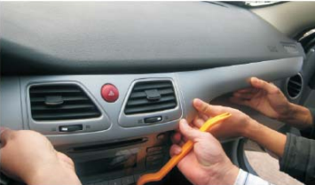
08 将整个空调面板向后拖出
