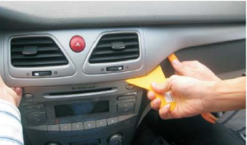
07 将整个空调面板撬松，确定扣位都撬开
