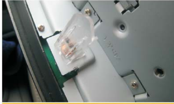
19 拆原车固定胶扣，然后装到本公司导航机器上，左右各一颗
