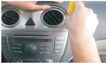
04 取下空调出风口, 拔出后端插座
