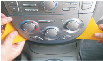
05 取下空调控制面板, 拔出后端插座
