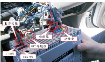
10 如图连接主机尾部各线束, 并将USB线及导航天线整理好
