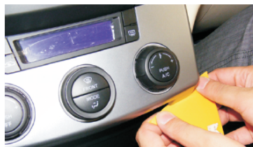
04 用胶刀撬起空调面板下侧的左右角
