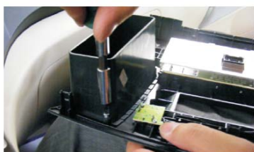
22 拧下原车面板两侧空调出风口的固定螺钉
