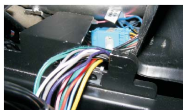
27 将本机提供的线束与原车对插, 收纳在槽内
