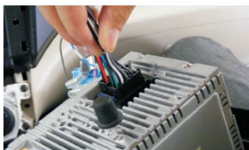
20 将取下的橡胶塞装入本机尾部
