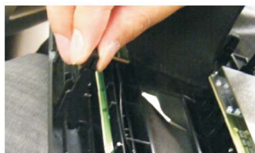
21 依次拔出原车面板上的卡扣
