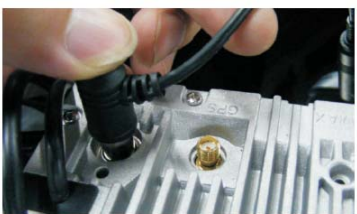
29 将尾部的收音延长线插入本机尾部
