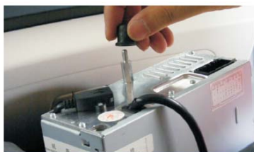
19 取出原车机箱背面的橡胶塞
