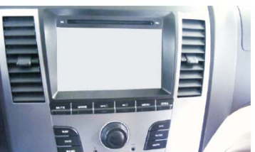
30 将本机装回原车中控部分
