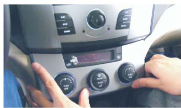
31 将空调控制面板装回本机面板下部
