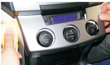
05 用胶刀翘起空调面板上侧的左右角
