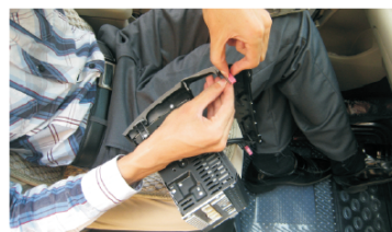
15 拆下CD上的四个卡子装在DVD导航上
