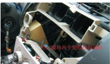
16 沿红线将两个塑胶扣钩剪掉
