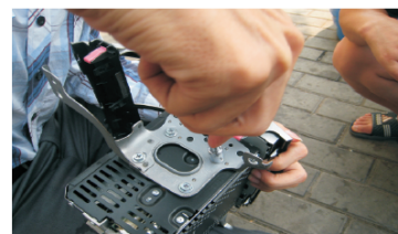
13 拆下CD左安装支架装在DVD导航上
