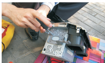
14 拆下右CD左安装支架装在DVD导航上
