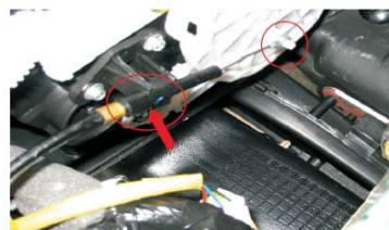
15 取掉空调拉线
