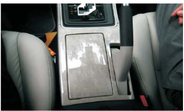
37 将手刹盖板推回原卡位
