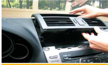
22 取出空调通风口，拔掉应急灯开关及显示器的插头
