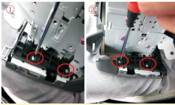
26 取掉原车CD主机后面板的2个塑料固定支架（各2颗螺丝）
