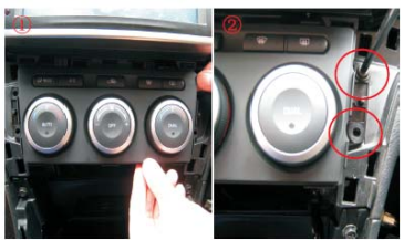
33 将空调控制器插头连接上，将空调控制器推入固定卡位并用4颗螺丝固定
