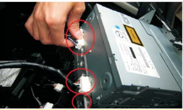
25 拔掉原车CD主机后的的3个插头
