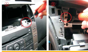
23 取掉原车CD主机的4颗固定螺丝
