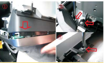
28 将原车CD主机拆下的塑料支架和装饰板分别固定在新的导航主机上
