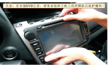
31 检查各连接线无误后，将马6睿翼专用主机推入螺丝固定卡位
