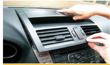
21 拉出空调通风口
