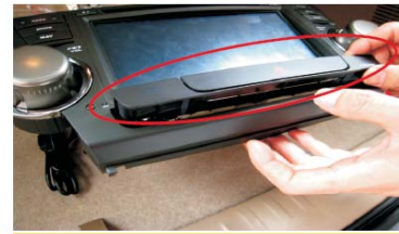
27 将应急灯开关安装到汉兰达专用主机
