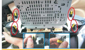
23 取下原车的4个固定卡扣
