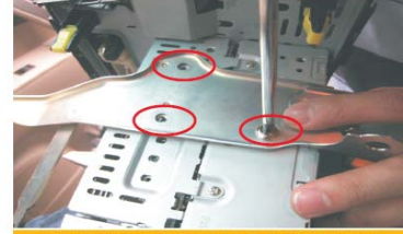
21 取掉原车CD主机的固定支架（左右各3颗丝）
