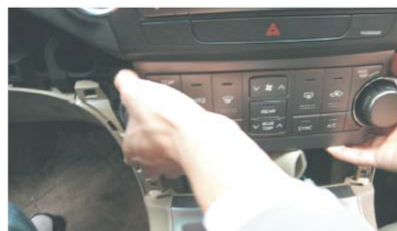
13 拉出空调控制器（注意力度），拔掉空调控制器后面的1个插头
