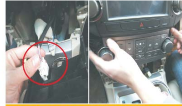
39 对接上空调控制器后面的1个插头，将空调控制器推入固定卡位
