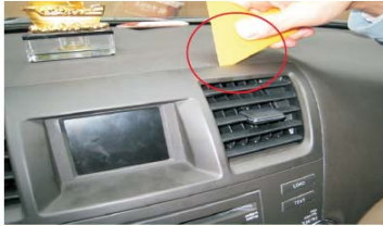
04 撬松空调通风口的右侧
