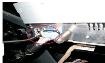
09 拔掉原车CD主机后面的电源/音响插头, 拔掉收音天线插头
