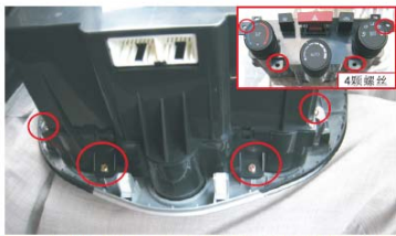
13 取掉原车CD大面板的空调控制器, 安装到海马欢动专用主机上
