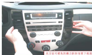
07 在烟灰缸后面推出原车CD大面板的缝隙处, 拉出原车CD大面板
