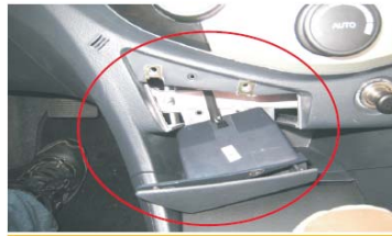
05 取出烟灰缸, 取掉烟灰缸后面的小灯
