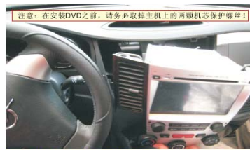
18 对接上应急灯开关插头和空调控制的两个插头; 将主机推入固定卡位
