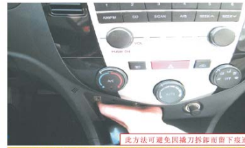
06 将手伸入烟灰缸后面, 往前推动原车CD大面板
