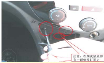
04 拉出烟灰缸, 取掉烟灰缸的3颗固定螺丝
