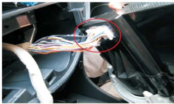
11 拔掉空调控制的两个插头
