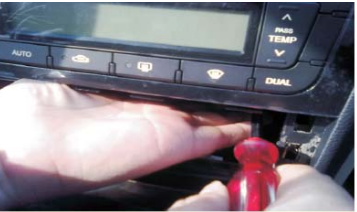
10 拆掉指示位置固定螺丝
