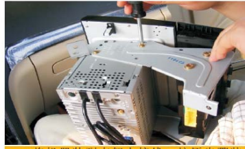
20 将机器装到支架上接线，按原步骤装回去。
