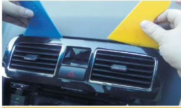
04 用胶刀从空调出风口上端插入，撬出出风口面板
