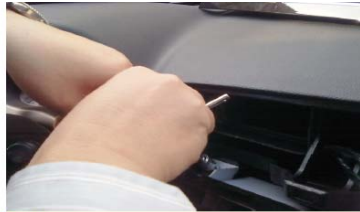
12 拆掉上端左侧固定螺丝
