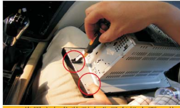
19 将固定扣位装到本公司车机上面，共四个位置。
