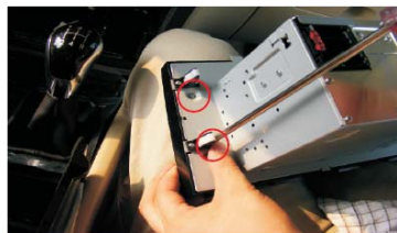
18 拆固定扣位（共四个）
