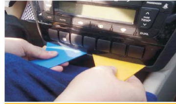
06 用胶刀从下面间隙插入
