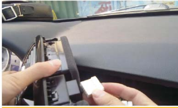
05 将空调口线拔掉
