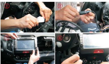
13 开始装导航DVD：对接上收音天线、导航天线、应急灯开关插座、USB转接线，并拆掉主机上的两颗机芯保护螺丝。
