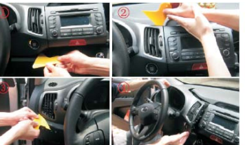
07 用胶刀撬松左边中控盖后，用手移开：
