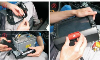
11 拆下原车CD机上的扣及报警灯、小屏并分别装在我们导航机上
