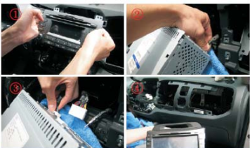
10 打开CD机固定螺丝，并用手取下CD机
