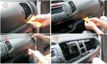
06 用胶刀撬松右边中控盖后，用手取下
