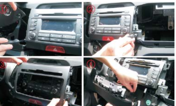
08 打开原车CD面框螺丝，并用手取下面框（拔掉警告灯排线及小屏排线）
