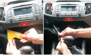
05 用镊子或小胶刀把此两处螺丝盖打开，后打开螺丝
