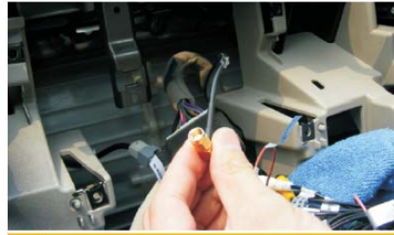
23 导航天线装到车上后把接头引到中控位
