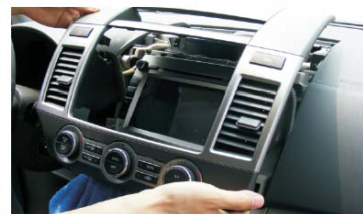
33 把5个插头插到外框相应位后, 装上外框, 注意理好线
