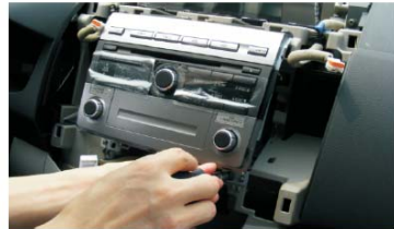
12 用十字螺丝刀拆下身下侧两螺丝
