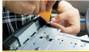
21 拆下原车CD机上三个扣子后装到DVD导航机上
