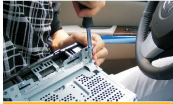
19 拆下原车CD机的装车支架
