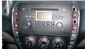
05 取下原车CD左右两侧四个固定螺丝
