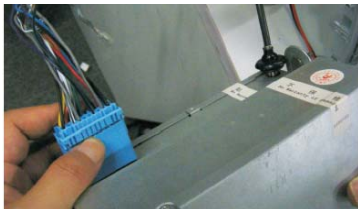
07 拔出原车CD主机机尾线
