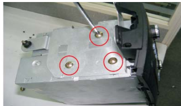
08 取下原车CD主机固定支架(左右各3颗螺丝)
