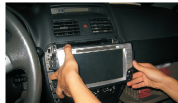
12 将铃木天语专用机推入原车CD主机固定位，通电测试主机
