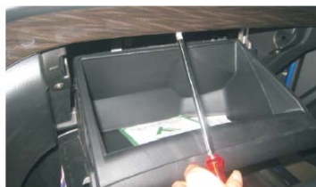
06 拆下右边装饰条的螺丝
