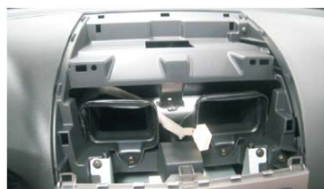
16 拆下上边两个固定CD的螺丝
