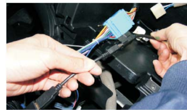
24 插上原车的USB引出线
