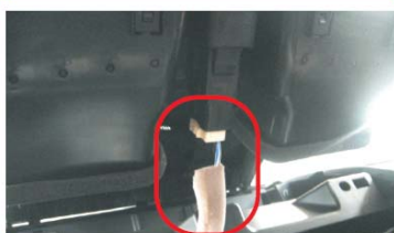
15 拔下应急灯开关的插头
