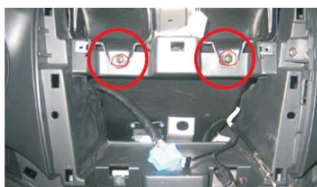
18 拆下两个固定出风口的螺丝
