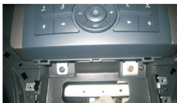
12 拆下下边两个固定CD的螺丝
