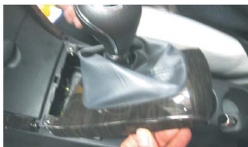
05 拆下档位盖板
