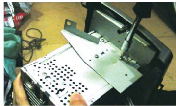
20 拆下原车CD的安装支架和卡子装在DVD导航上
