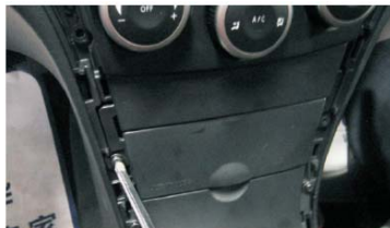
09 拆下固定空调面板和点烟器板的螺丝
