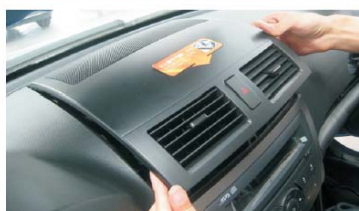
14 拆下出风口盖板
