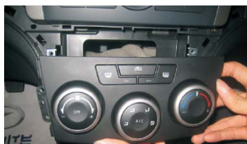
11 拆下空调面板
