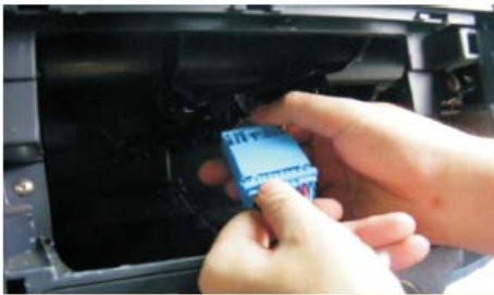
22 将我司电源尾线与原车电源尾线接上
