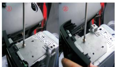
12 将原车CD装车支架装上我司DVD导航
