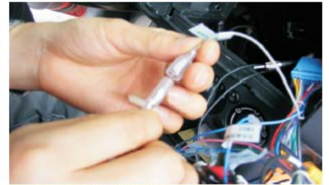
21 将我司电源尾线上的方控线与AUX线组上的方控线1对接
