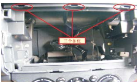
10 连同空调出风口面板一起取出原车CD，然后把空调出风口面板单独去出后在装回原位（空调出风口面板和原车CD的三个扣位）
