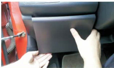
07 取下方向盘左下方的面板后，这边也有一个固定原车CD主机的六角螺丝，同样用六角套筒取下螺丝
