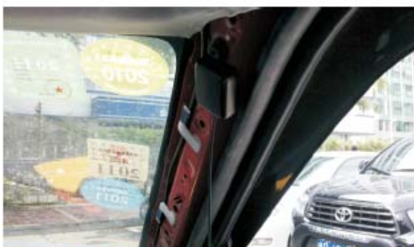
13 撬开右侧A柱的内饰面板，将我司导航天线吸附在车架上
