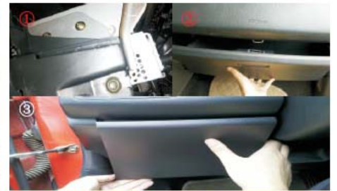
24 锁上固定装车支架的两个六角螺丝，然后装上储物盒和方向盘左下方的面板
