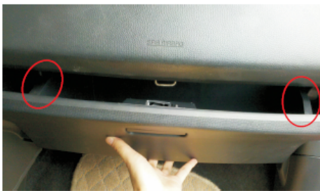
04 打开储物盒（双手往中间压此两个地方）然后储物盒可以打开到较大角度
