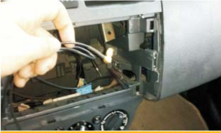
16 将导航天线插头穿过储物盒位置从原车CD出穿出后盖上右侧A柱内饰面板
