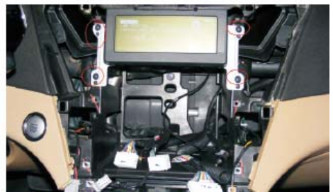
15 此步为中配版操作: 拆下4个螺丝, 取出显示屏
