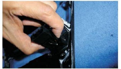
21 拆下停车警示灯开关，并装到DVD导航机附带的外框面板上
