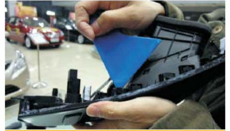
18 拆开扣位，取下右出风口，并装到DVD导航机附带的外框面板上
