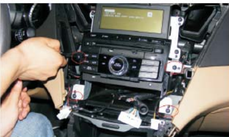
13 拆下4个螺丝, 取出主机
