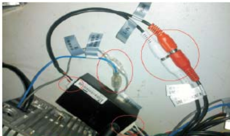
25 中配（带数字功放控制盒），把电源转接线上空调数据+（蓝色）和空调数据-（灰色）分别与主机上尾线空调数据+（蓝色）和空调数据-（灰色）对接，然后把数字功放控制盒的L-IN和R-IN与RCA线上两个A面右声道输出对接
