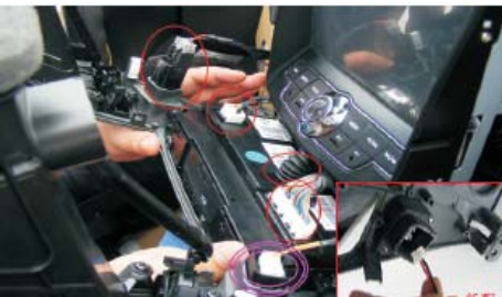
28 把外框装到车上：把图示5个插头插到相应位置，（其中下侧三个圆圈住的安全带指示灯在低配车上有所不同：用附带转接线接显示屏插头），再把外框装到车上，固定好下侧两个螺丝
