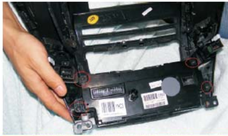
20 拆下空调盒的4个螺丝，取出空调盒（有5个扣，扣的位置可参照DVD导航机附带的外框面板），并装到DVD导航机附带的外框面板上
