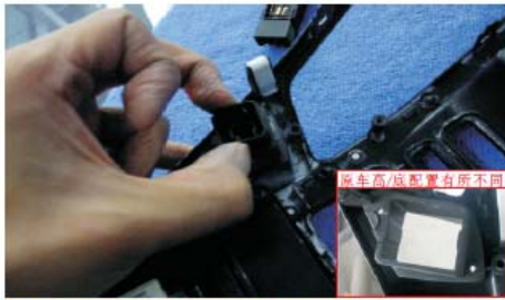
22 中档配置车拆下安全带指示灯，并装到DVD导航机附带的外框面板上
