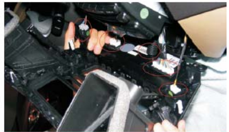
12 拔下插头和管子 (低配无右侧安全带警示灯插头)
