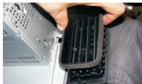
21 将空调出风口和卡扣分别装在本机的面板上
