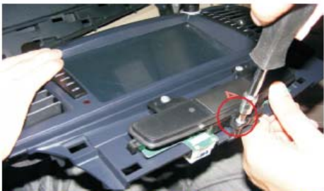
22 将原车的故障灯面板固定在本机面板上
