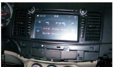
25 将本机装入原车，通电测试各项功能
