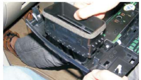
15 取出CD面板两侧的空调出风口
