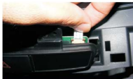
18 拔出应急灯面板的FPC排线
