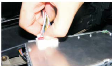
20 拔出CD机背面的线束和收音天线
