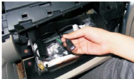
23 将本机尾部的USB线束穿入，放置在副驾储物盒
