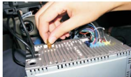
24 将GPS、收音天线、电源线束等插入主机背面
