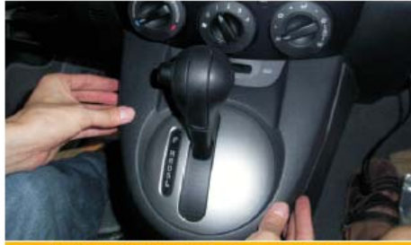
17 依序分别把中控大盖、左右侧盖、档位上盖、储物盒，装回原位
