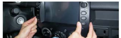
12 把CD主机固定面板上的两颗螺丝取下，撬松后取出
