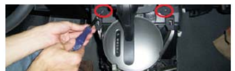
09 用胶刀撬松挡位盖后将其取下
