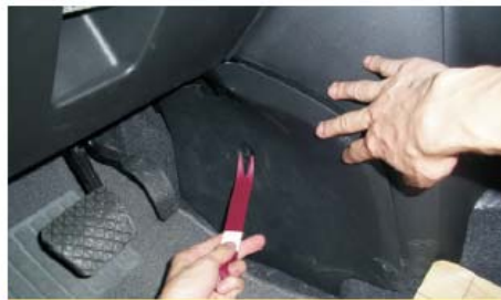
08 用胶刀把中控左侧小盖胶钉撬开后并取下
