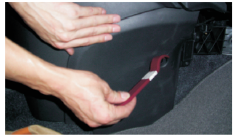
06 用胶刀把中控右侧小盖胶钉撬开
