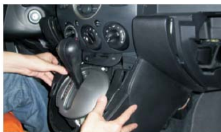
11 将中控大盖用手拆下
