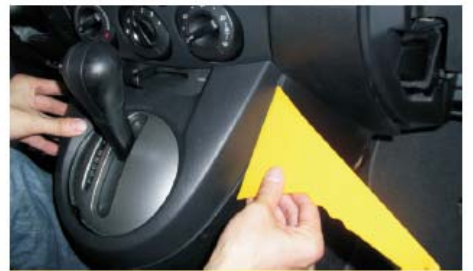
09 用胶刀撬松挡位盖后将其取下
