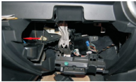
05 用套筒把原车CD主机上的右侧边固定螺丝取下，(箭头所指内部)
