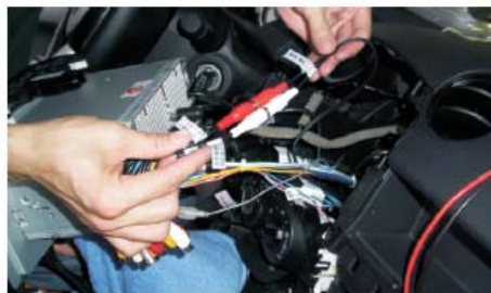
14 安装专用导航DVD，插好所有的端口线(报警开关线、USB转接线、电源线、方控、GPS线等)，调试OK
