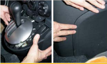
16 依序分别把中控大盖、左右侧盖、档位上盖、储物盒，装回原位
