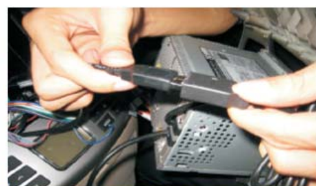
21 对插上USB输入线，插上收音天线插头和GPS天线插头
