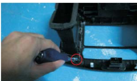
12 拆下应急灯开关和左右空调出风口
