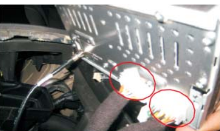
11 拔下电源插头和收音天线插头
