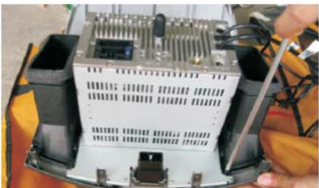
13 将应急灯开关和左右空调出风口装在DVD导航上
