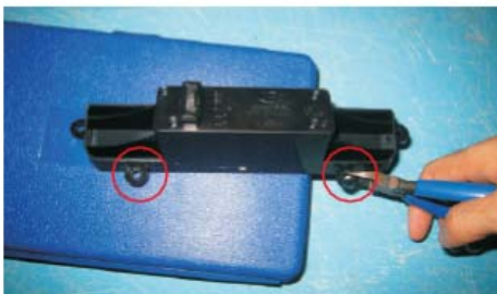
15 剪下时钟显示器的两个螺丝定位耳朵
